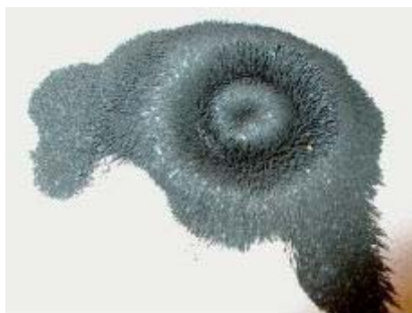
TWEE-POLIG MAGNEETVELD ZICHTBAAR GEMAAKT DOOR IJZERKORRELS
